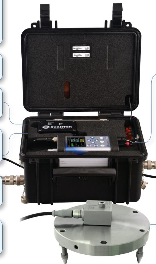
A estação é baseada no **SVAN 958A** que pode ser facilmente removido do processo e utilizado como som de mão e medidor de nível de vibração.
